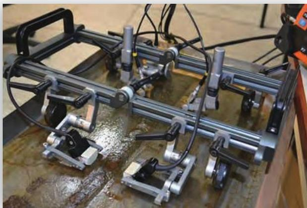
Сканер UHTS-X02 совместим с ультразвуковыми дефектоскопами позволяющие реализовывать PA и TOFD - метод. Сканер применяется для контроля кольцевых сварных соединений труб диаметром от 500 мм. Для контроля продольного сварного соединения сканер можно сложить по центру.
