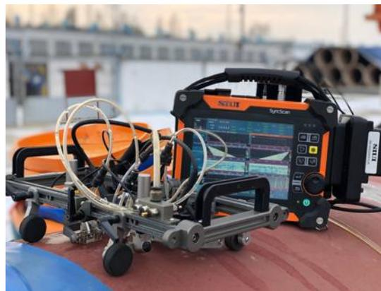
Сканер UHTS-X02 совместим с ультразвуковым дефектоскопом SyncScan который имеет возможность реализовывать метод PA и TOFD методы, позволяющие значительно увеличить скорость сканирования.
