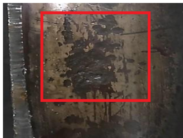
С-скан точечной коррозии труб
