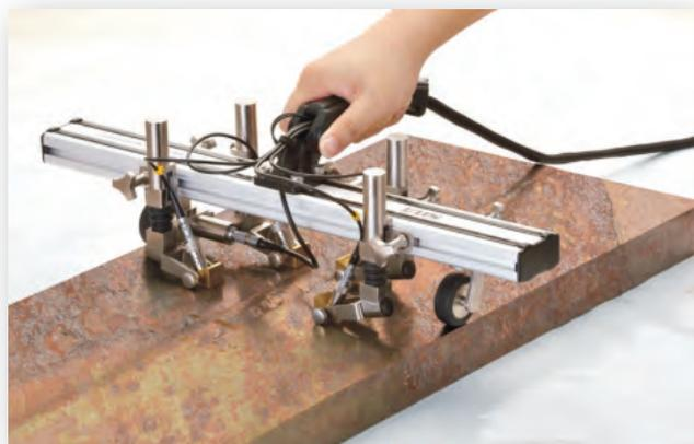
Сканер TSB-1-P05 и TSB-2-P05 совместим с ультразвуковыми дефектоскопами с возможностью реализации TOFD - метода.
