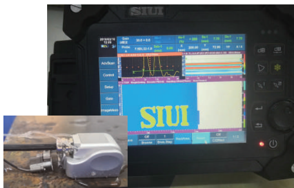
Контроль пластины толщиной 8мм
