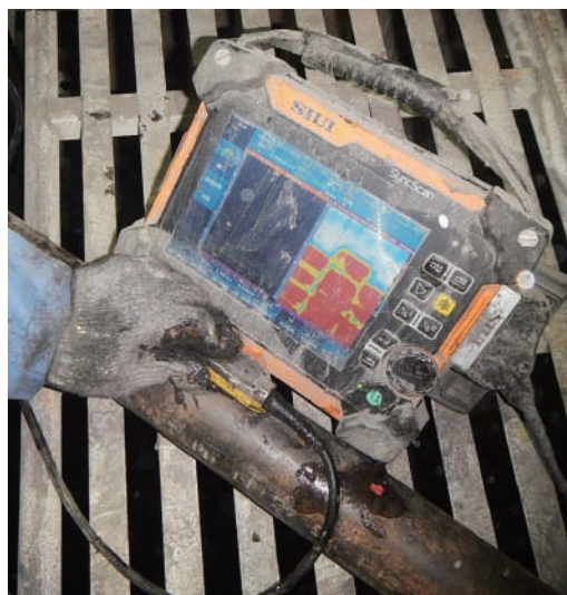
Контроль трубы парогенератора
