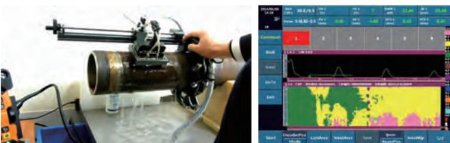
РА сканер для контроля коррозии (XY направление)
