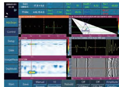
Одновременный контроль РА и TOFD позволяет расширить охват сварного шва и исключить пропуск дефектов.
