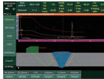
Измерение глубины залегания дефекта
